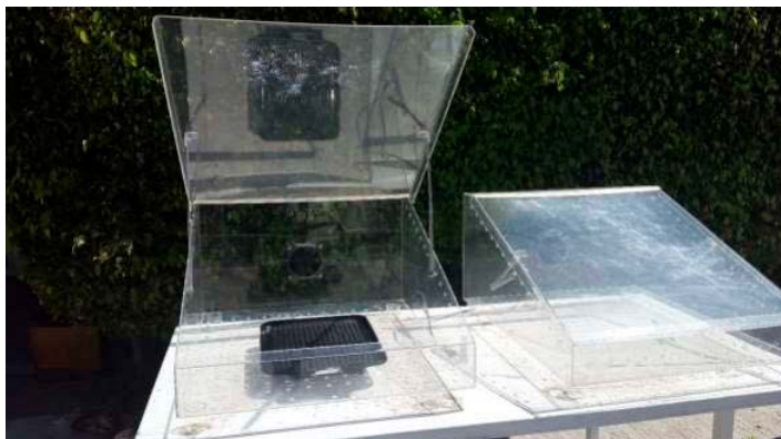
Figura 1. Secador solar tipo gabinete utilizado en el estudio experimental, operando en modos activo y pasivo para la deshidratación del tomate verde.
