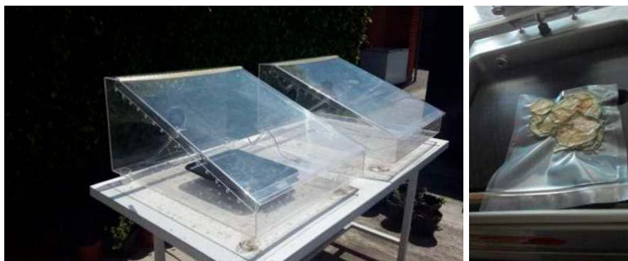
Figura 2. a) Secadores tipo gabinete convección natural y convección forzada, b) Producto deshidratado sellado al vacío.
