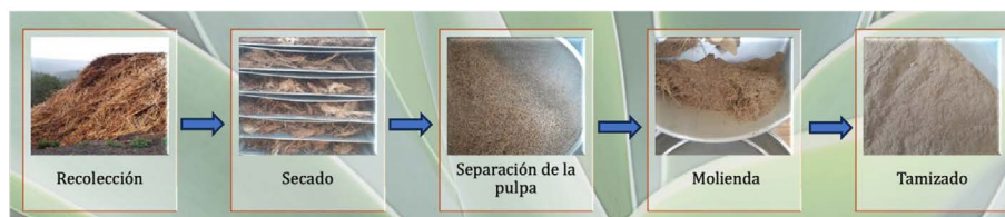
Figura 3. Proceso para la obtención de residuos finos de agave
