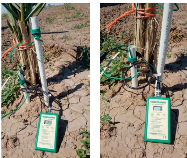
Figura 45. Estación de monitoreo con sensores de humedad a 30 cm de profundidad con 21 Centibares y 60 cm de profundidad con 0 Centibares.
