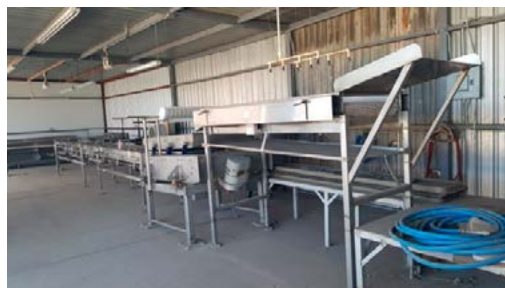
Figura 141. Equipo semiautomatizado de selección para el dátil en el área de empaque.
