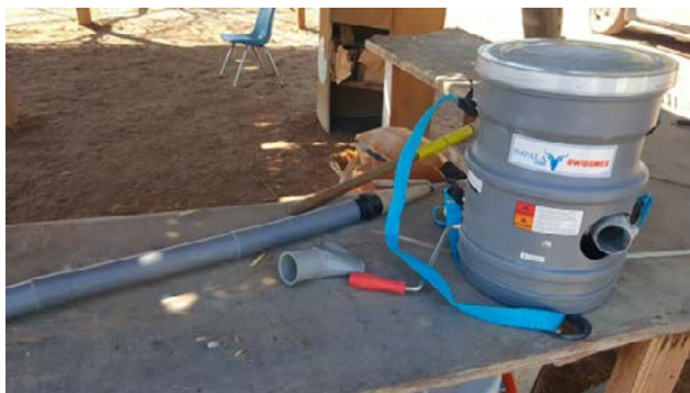
Figura 64. Equipo manual para polinización de palma datilera.
