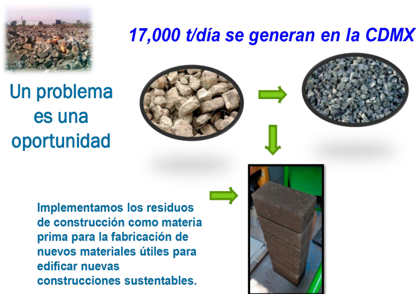
Figura 10 Bloques fabricados con RCD
