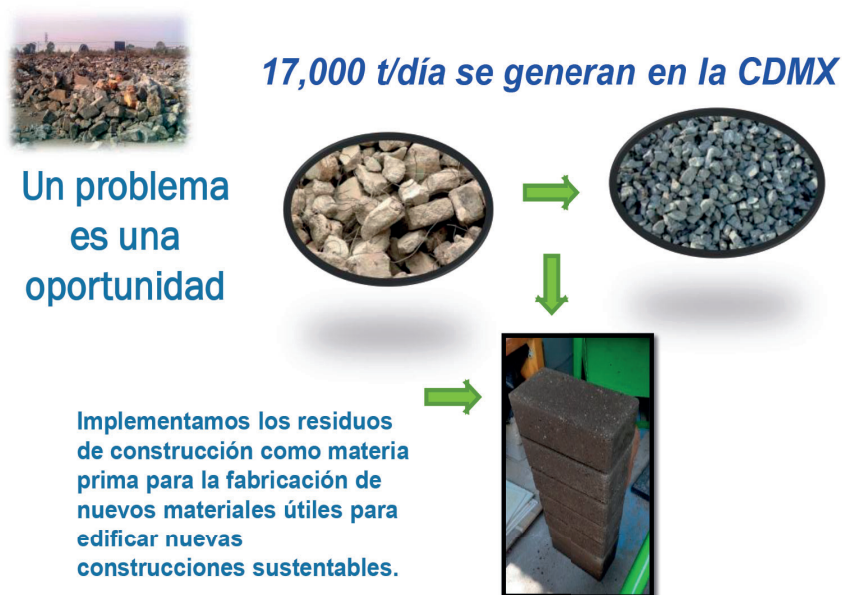
Figura 10 Bloques fabricados con RCD
