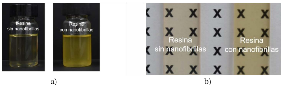
Figura 26. Muestras de UP sin y con presencia de 0.5 % de nanofibrillas de celulosa. a) antes del curado; b) después del curado Fuente: Elaboración propia.
