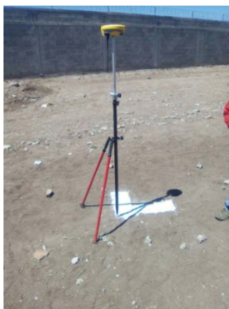
Figura 3. Mediciones GPS de los puntos de control fotogramétricos.
